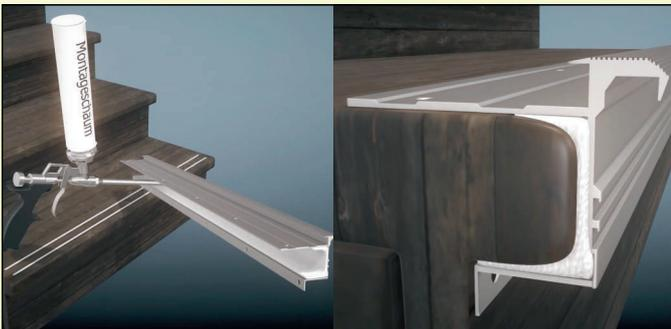
**Tipp:** Spritzen Sie Montageschaum in das Treppenprofil ein bevor Sie es auf die alte Trittstufe aufsetzen. Der eingespritzte Montageschaum füllt den Hohlraum aus, dies hat schalltechnische Vorteile und die Treppe hört sich beim Begehen nicht „hohl“ an.
