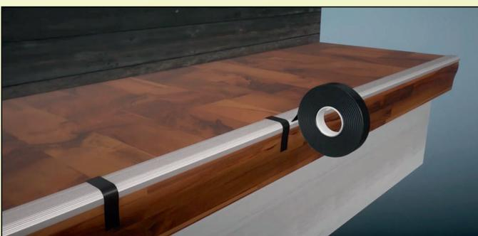
Setzen Sie die Holzblende ein und drücken diese fest gegen das Aluprofil. Zum Fixieren bis der Montagekleber angezogen hat können Sie die Holzblende mit Klebeband oder Klemmzangen fixieren.
