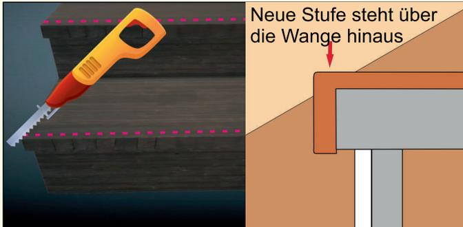
Es könnte unter Umständen nötig sein dass Sie bei Ihren bestehenden Stufen 2 cm an der Vorderkante absägen müssen sollte die neu aufgesetzte Laminatstufe über dem Niveau der seitlichen Wange liegen, also dass die neue Stufe über die Wange hinaus ragt. Testen Sie dies zu Beginn gleich mal aus durch Auflegen einer Stufe oder messen Sie es aus. Die Stärke der Stufenvorderkante unserer Laminatstufen beträgt 20 mm.
