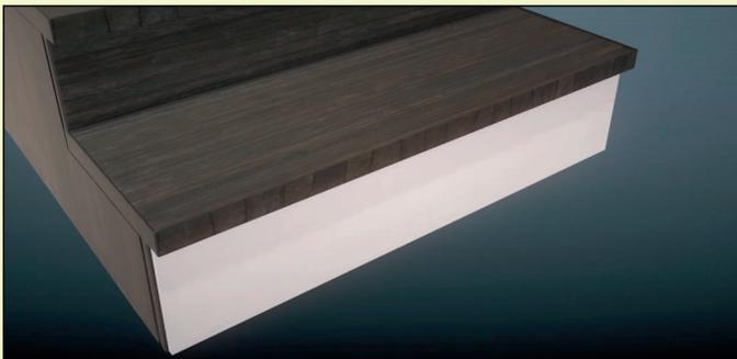
Setzen Sie die neue Stellstufe ein und drücken diese fest bis der Montagekleber etwas angezogen hat.
