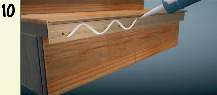
Bringen Sie für das Verkleben der Holzblende ausreichend Montagekleber auf das Aluprofil auf.
